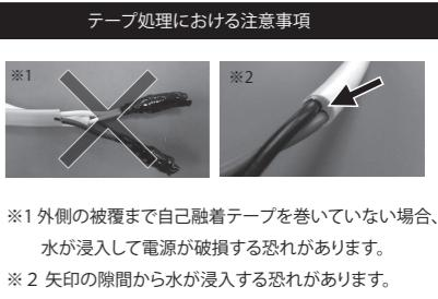
※1 外側の被覆まで自己融着テープを巻いていない場合、水が浸入して電源が破損する恐れがあります。
