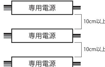
※専用電源は必ず10cm以上離して設置してください。
