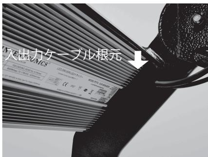
②専用電源の入出力ケーブルの根元に雨水がつたっていない様に根元より下げてご使用ください。
