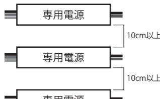
※専用電源は必ず10cm以上離して設置してください。
