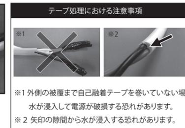
※1 外側の被覆まで自己融着テープを巻いていない場合、水が浸入して電源が破損する恐れがあります。
