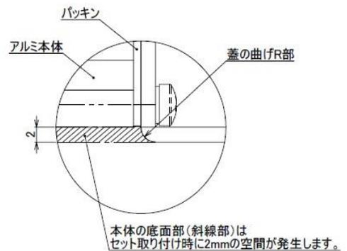
高天井LED【RED】700 専用電源 製品外形図
