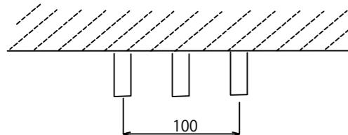
※チタン製の取付けボルトを推奨します。
