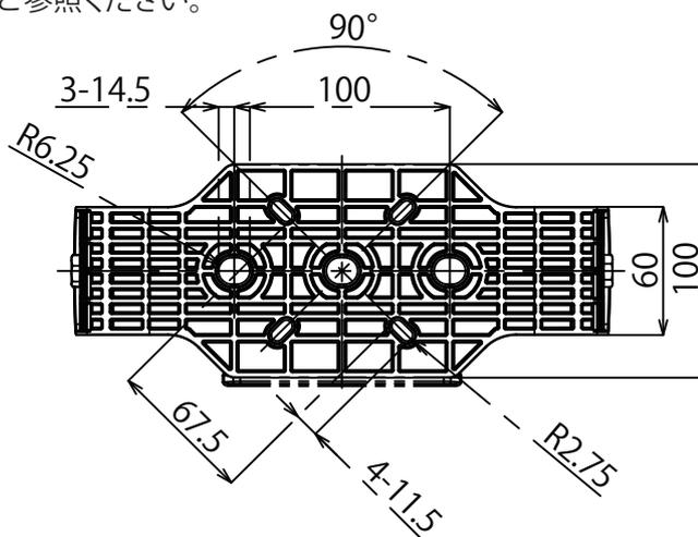
※チタン製の取付ボルトを推奨します。
