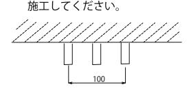
※チタン製の取付ボルトを推奨します。
